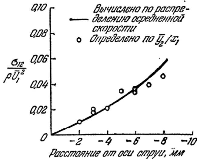
Рис. 5.8. Распределение напряжения сдвига в плоской свободной струе в сечении на расстоянии 100 мм от сопла шириной 5 мм [46].
